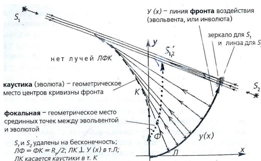
Рис. 1. Формирование ветвей каустики (эволюты) и фокальной линии гладким фронтом (инволютой, или эвольвентой)
